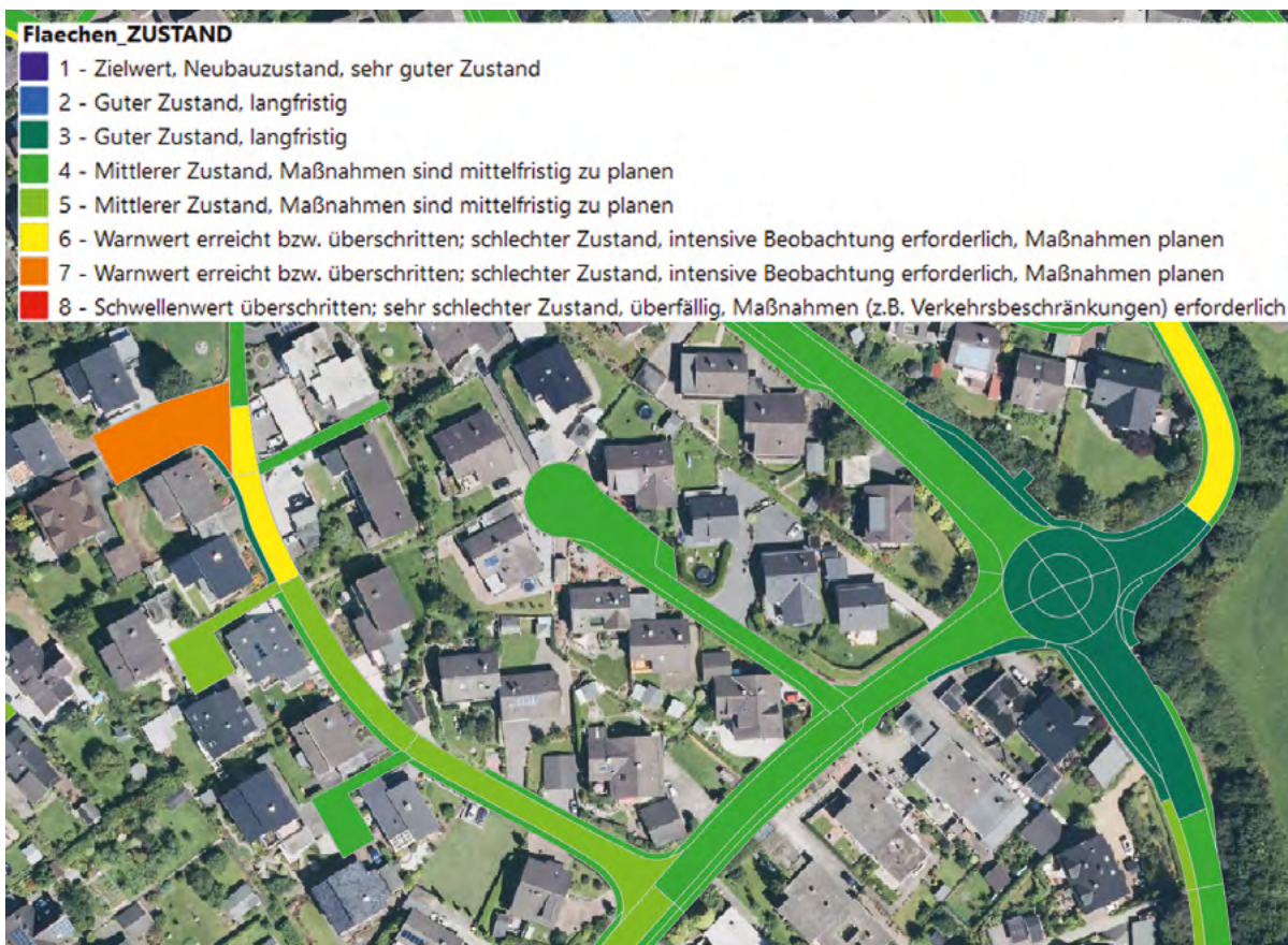
Darstellung aus dem Geoinformationssystem: Nach Zustandsklasse eingefärbte Straßenflächen in der Gemeinde Finnentrop
